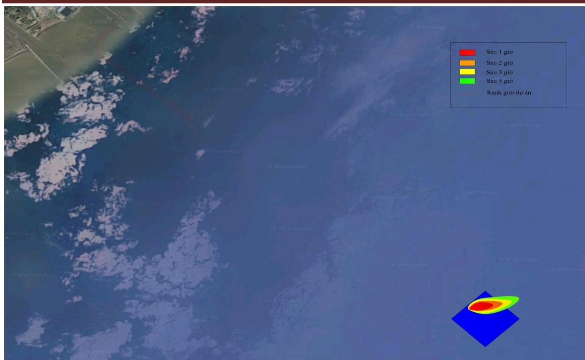
Hình 3.37. Hành vi di chuyển của các vết dầu tràn sau 1h, 2h, 3h và 5h khi xảy ra sự cố dầu tràn ở điểm tràn dầu số 4 vào mùa gió Tây Nam (vận tốc gió lớn nhất 12m/s, hệ số khuếch tán ngang \zeta = 0,12m^2/s )
